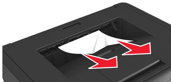
**2** Din panoul de control al imprimantei, selectați **Next (Următorul)** > **OK** >**Clear the jam, press OK** (**Eliminați blocajul, apăsați OK**) > **OK** pentru a șterge mesajul și a continua imprimarea.
